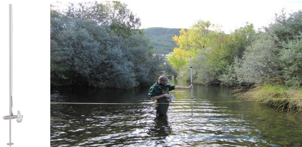
Figura 12. Izquierda: Molinete Hidrométrico; Derecha: Uso del Molinete Hidrométrico
