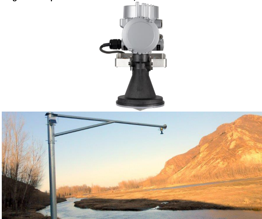
Figura 11. Izquierda: Sensor Radárico; Derecha: Sensor Radárico Instalado
